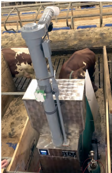
Ei ku på vei inn i metangassmåleren på Mære landbruksskole. Foto: Sverre Lang-Ree
