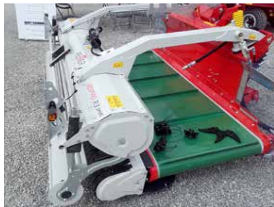
Frontmontert pick up rive som frakter gras sideveis. Foto: Einar Båffjelldal, NLR Nord-Norge
