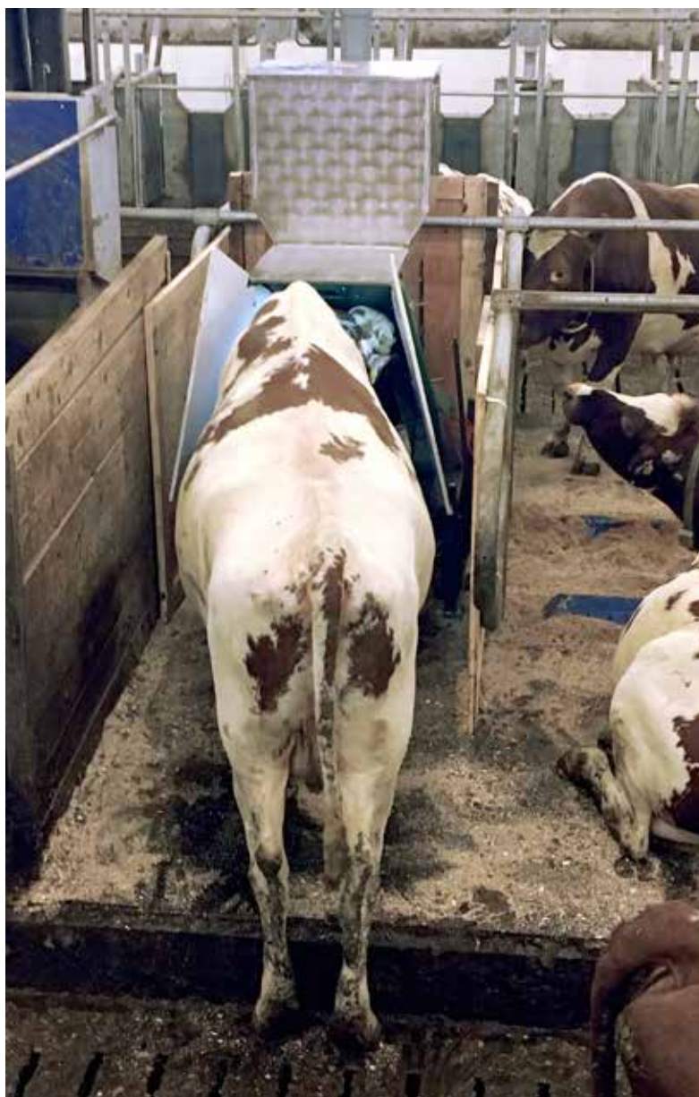
GreenFeed-maskinen fungerer som en kraftfôrautomat og lokker dyrene til seg flere ganger daglig ved å gi litt kraftfôr. Pust og rap fra dyret dras inn i maskinen med en vifte og gassinnhold registreres i en sensor.
