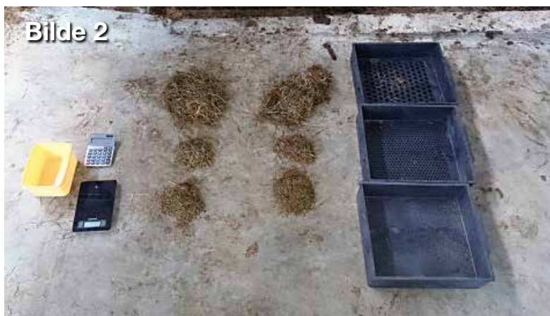
Måling av sortering av fullfôr med separasjonsbokser som er tre bokser som settes oppå hverandre og ristes etter et bestemt mønster (de to øverste har hull av ulik diameter og den nederste er tett).
