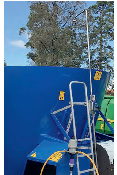
Med dusjhodet festet i en enkel brakett er det enkelt å hekte det på og ta det bort igjen før utføring. Foto: Harald Støyl.
