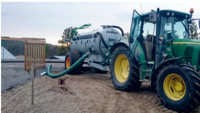
Ekstern mukk-kumme fra Vangstad (2018). Kummen har bunn-uttak på motsatt side for stasjonærpumpe og slepeslanger. Foto: Privat.
