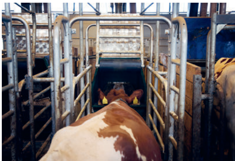
Så langt er ca. halvparten av de 15 bestilte «Greenfeed»-maskinene som skal måle metanutslipp fra kyr installert. Her fra forsøksfjøset ved NMBU. Foto: Aurora Hannisdal.
