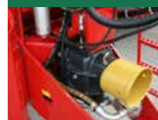
Shifttronic automatgear- kasse for dieselbesparelse og ideell til hurtig blanding av kompaktfôr.
