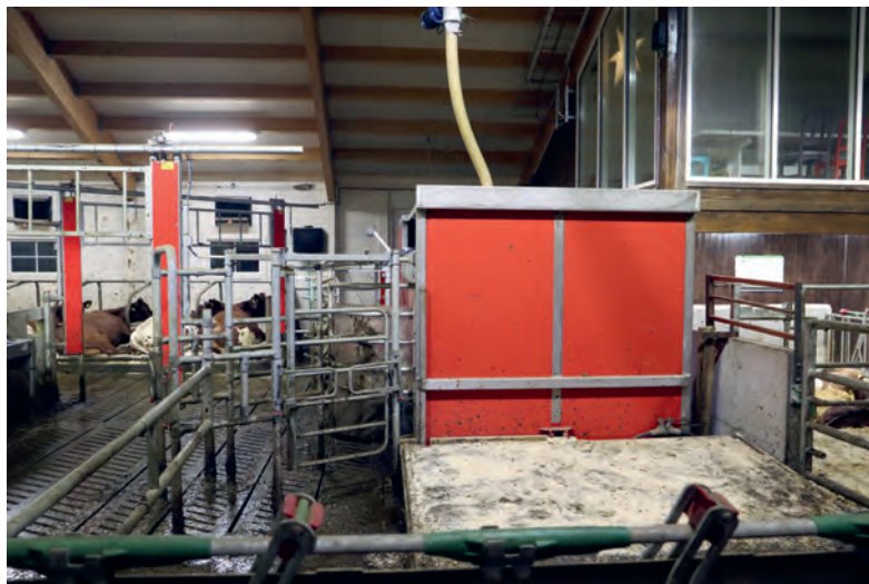
Den røde kontaineren inneholder melkeroboten. Den kan enkelt hektes på en traktor og kjøres til setra.
