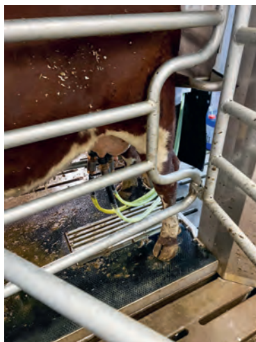
Stimulering skjer med en egen spenekopp. Under påsett føres to og to spenekopper fram. Etter påsett trekkes robotarmen tilbake til teknisk rom.
