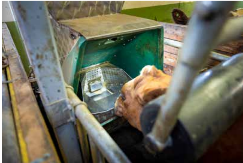
Metanmåler (Greenfeed) monteres nå i alle besetningene som registrerer individuelt fôropptak. Foto: Espen Solli
