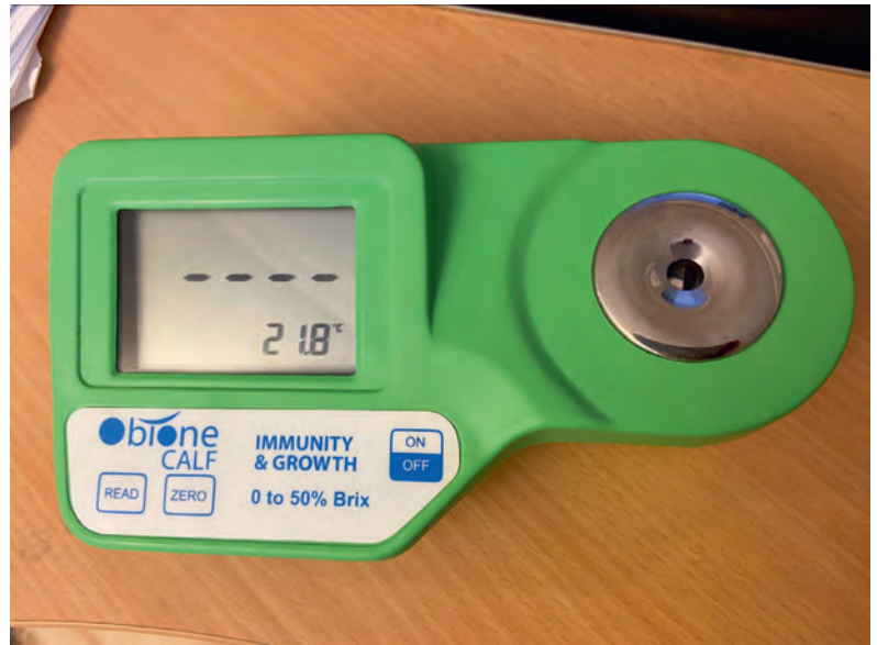
Brix refraktometer til måling av råmjølk og serum frå kalv, sjå tabell 1 og 2 for tolkning av verdiar. Hugs godt reinhald og kalibrering etter anvisning.
