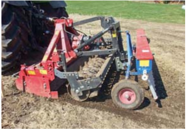
Horisontalfres med såaggregat. Foto: Jan Karstein Henriksen
