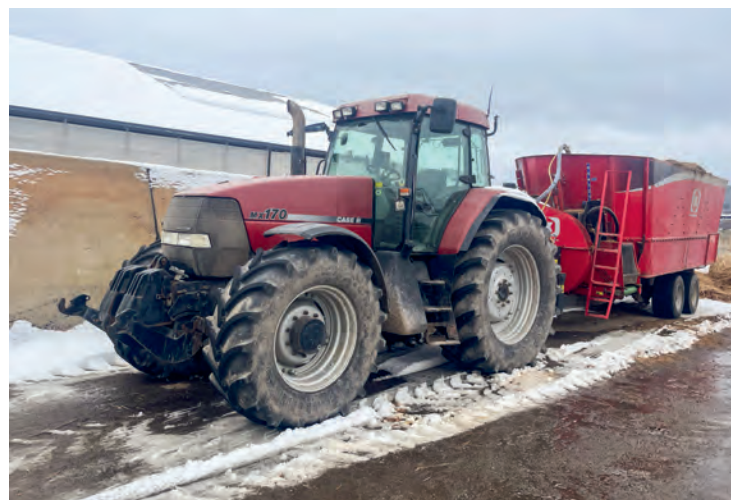
En traktordrevet mobil mølle lager alkalisk korn ved å blande urea og maxammon med valset korn.
