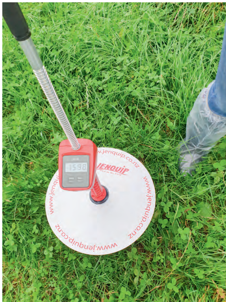
Hans Lund demonstrerer en digital høydemåler for beitegras. Denne typen er fra Irland, og gir deg enkelt et snitt over grashøyden på beitet.
