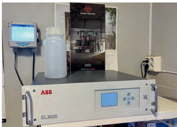
Metansensor fra ABB som brukes i olje- og gassindustrien testes ut i forsøket. Foto: Stine Vhile
