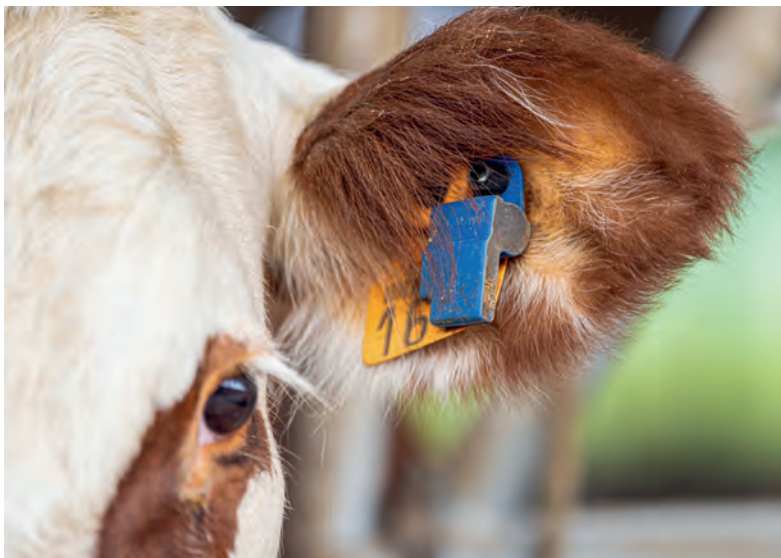
DeLaval øremerkesensor registrerer aktivitet, drøvtygging og etetid og integreres med data fra med andre sensorer. Foto: DeLaval
