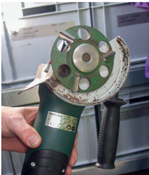
Vinkelsliper med fres med 3 faste kniver og spesialtilpasset håndtak. Foto: Terje Fjeldaas
