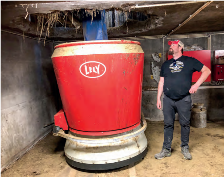
Arild ved sida av fôringsroboten Lely Vector som får grovfôr rett frå fylltømmaren til siloen og kraftfôr frå eine kraftfôrsiloen.
