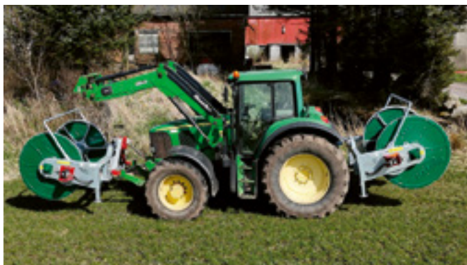
Slepeslangeanlegg og vakuumbogner
