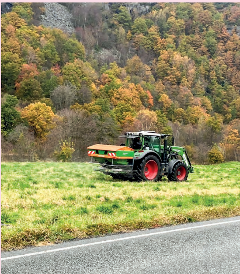
Amazonspreder rigget for å spre inntil 54 m bredt i beiter eller 36 m med granulert kalk. Sprer jevnt i full arbeidsbredde. Foto: Tor Harald Staddeland
