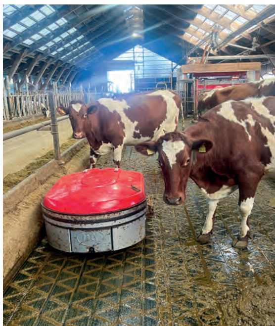
Gjødselroboten samler opp gjødsla og spylor gulvet. Det er lagt Zigzag-gummiblegg på betongunderlaget.
