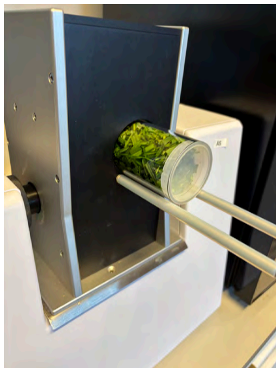
Ferskt gras som er klippet opp og blandet sendes gjennom våt-NIRS instrumentet for analyse.
